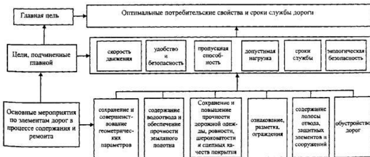
Рисунок 1 - схема целей и задач планирования работ по содержанию и ремонту дорог
